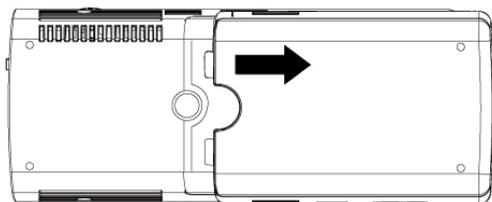
2. 将电池接触面与主机接触面连接，置入电池
